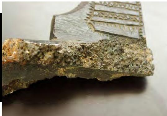
Abb. 2: Mit Poren durchsetzte Bruchfläche. Außerdem zu erkennen der ausgebrochene Bereich im Wappen, der auf eine verstärkte Kammer hinweist.
