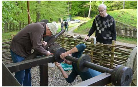
Abb. 7: Ausbau der Seilwinde nach ihrer Zerstörung
